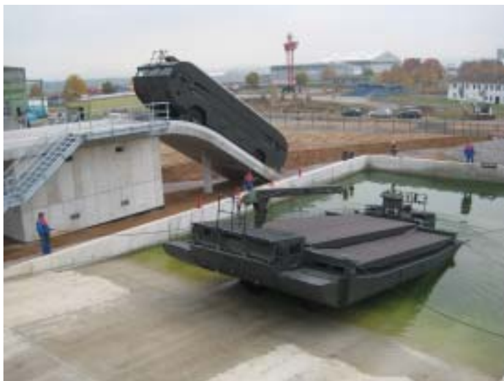
Zweimal das amphibische Brücken- und Fährenfahrzeug M3: Bei der Überfahrt über die Sechzig-Prozent-Rampe und ausgeklappt im Wassertestbecken
