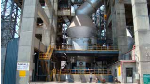
Walzenschüsselmühle MPS 5600 B von Gebr. Pfeiffer SE für die Vermahlung von 650 Tonnen Zementrohmaterial pro Stunde. Der Kunde ist Gujarat Ambuja Cement Ltd. in Indien.
