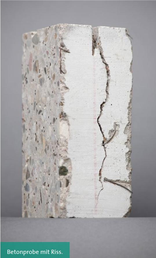
Betonprobe mit Riss.
