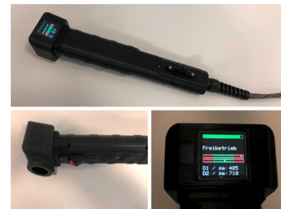
Der Messkopf des mobilen Terahertz-Systems bietet ein Farbdisplay mit Signalstärke-Feedback, Betriebsmodus und Schichtdicken-Ergebnissen.
