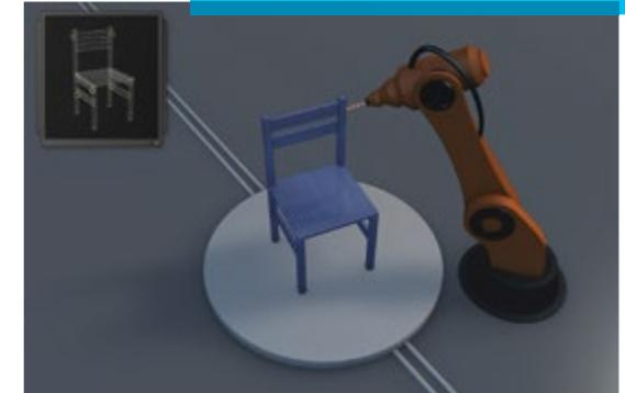
Während die Forscher vom IPA das Projekt koordinieren und sich der Lackiertechnik sowie der Simulation der Lacktröpfchen nah am Zerstäuber widmen, kümmern sich die schwedischen Kollegen um die Simulation nah am Bauteil sowie um die automatische Bahnplanung. Genauer gesagt: Sie berechnen, wie die Lacktröpfchen durch die Luft fliegen, wo sie auf dem Objekt landen und wie dick die entstehende Schicht ist.
